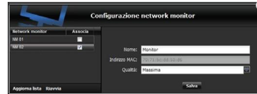
*Nel campo "Nome" è possibile indicare il nome assegnato a questo monitor (negli esempi NM 01 e NM 02). Il campo "Indirizzo MAC" viene compilato in automatico con i dati del sistema.*
